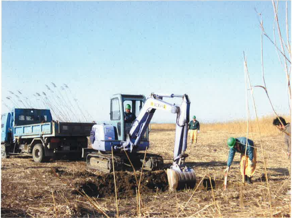
図1. 渡良瀬遊水地第2調節池のヨシ群落における土壌採取の様子.
